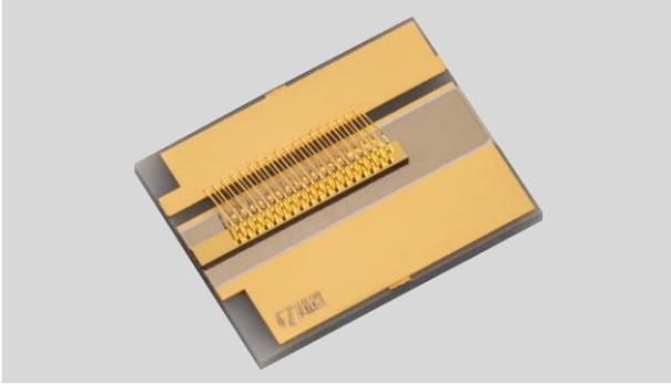
天元激光提供 TY-915±10nm-13.0W-25C-COS-100-01 无制冷 COS 封装激光器，采用金锡焊、P Down 封装、高可靠性、输出功率稳定、功率高、效率高、长寿命、兼容性高的一款产品，在市场上得到广泛应用。
